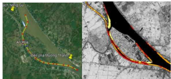
Hình 6. Đoạn sông Năng Cù – phà Mương Thanh và vị trí bị xói (Từ ảnh vệ tinh - màu đỏ)
